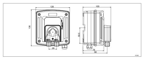
Fig. 8: Dimension sheet for DF2a
